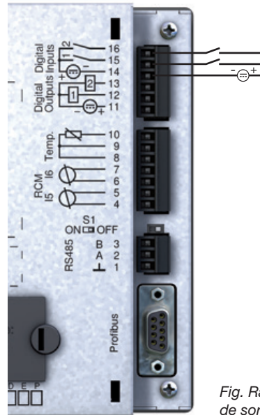
Fig. Exemple pour le raccordement des contacts de commutation externes S1 et S2 aux entrées numériques 1 et 2.
